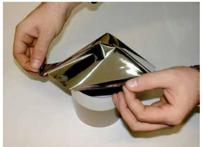
Ενώ το χάρτινο στεφάνι είναι τοποθετημένο στο σκίαστρο ενός διοπτρικού (ή στο σωλήνα του κατοπτρικού ή καταδιοπτρικού) τηλεσκοπίου, κόβουμε ικανή επιφάνεια του ηλιακού φίλτρου έτσι ώστε να προεξέχει από το χάρτινο στεφάνι περίπου 2 πόντους.
